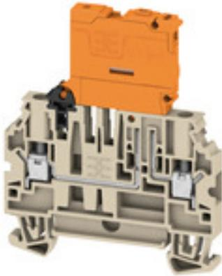
Dans certaines applications, il est logique d'ajouter un point de test ou un élément de déconnexion au terminal traversant à des fins de test et de sécurité. Avec les blocs de jonction sectionnables de test, vous mesurez les circuits électriques en l'absence de tension. Bien que la ligne d'air et de fuite des points de déconnexion ne soit pas évaluée en termes dimensionnels, la force de tension de choc nominale spécifiée doit être prouvée.
