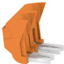
Le pont de court-circuit peut être inséré simplement et rapidement dans les blocs de jonction. Si plusieurs leviers sont connectés simultanément avec le connecteur de leviers, la « fermeture avant rupture » peut être réalisée. Une fois monté, le pont de court-circuit ne peut pas être retiré de l'application.
