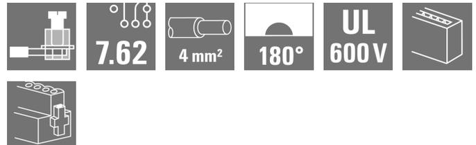
Connecteur femelle à 180° au pas de 7,62 pour réseaux IT. Satisfait les exigences de UL1059 600 V classe C. Associé au connecteur mâle SL 7.62 IT.... Avec contact principal. Satisfait les exigences étendues de 5,5 mm de protection de contact pour réseaux IT, conformément à CEI 61800-5-1 pour 400 V avec la terre. La bride centrale à verrouillage qui peut optionnellement être vissée réduit l'espace nécessaire de la largeur d'un pas par rapport aux solutions conventionnelles.
