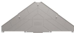
Une séparation est utilisée pour la séparation optique de circuits ou pour l'isolation électrique des connexions transversales adjacentes. Contrairement au flasque de fermeture, le contour peut être plus grand que les blocs de jonction adjacents. Toutefois, il ne devrait pas être plus petit, sinon les distances de dégagement et de fluage requises à l'intérieur de l'application ne peuvent plus être maintenues.
