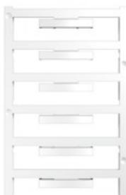
Le repérage de blocs de jonction WAD convient pour les bornes de la série W ainsi que les équerres de blocage WEW 35/2 et ZEW 35/2. Les repérages sont disponibles vierges, en impression spéciale ou en impression standard avec le symbole de la foudre. Les repères MultiCard de type WAD sont indiqués pour le marquage avec les imprimantes PrintJet CONNECT.
