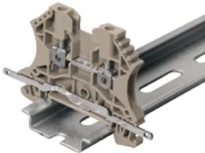
Avec le LS 2.8 WDU2.5-10, de nombreux blocs de jonction modulaires de passage des séries W peuvent être convertis très facilement. L'insertion de la tresse LS 2.8 WDU2.5-10 permet de boucler la tresse du blindage du câble directement au bloc de jonction par soudure ou à l'aide d'une patte de câble plat appropriée.
