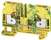
Eine schützende Durchgangsreihenklemme verbindet für Sicherheitszwecke eingesetzte elektrische Leiter und wird in vielen Anwendungen benötigt. Die elektrische und mechanische Verbindung zwischen Kupferleitern und der Befestigungsauflage wird mithilfe von Schutzleiterreihenklemmen hergestellt. Sie verfügen über ein oder mehrere Klemmstellen für die Verbindung mit und/oder Abzweigung von Schutzleitern.
