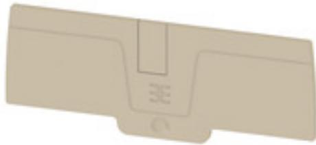
Abschlussplatten werden an der offenen Seite der letzten Reihenklemme vor dem Endwinkel befestigt. Mit dem Einsatz der Abschlussplatte wird die Funktion der Reihenklemme sowie die angegebenen Bemessungsspannung aufrechterhalten. Ein Berührungsschutz von Spannungsführenden Teilen wird gewährleistet, und die Abschlussklemme ist fingersicher.
