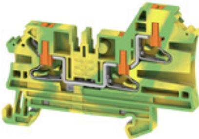
Eine schützende Durchgangsreihenklemme verbindet für Sicherheitszwecke eingesetzte elektrische Leiter und wird in vielen Anwendungen benötigt. Die elektrische und mechanische Verbindung zwischen Kupferleitern und der Befestigungsauflage wird mithilfe von Schutzleiterreihenklammern hergestellt. Sie verfügen über ein oder mehrere Klemmstellen für die Verbindung mit und/oder Abzweigung von Schutzleitern.
