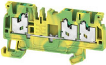
Eine schützende Durchgangsreihenklemme verbindet für Sicherheitszwecke eingesetzte elektrische Leiter und wird in vielen Anwendungen benötigt. Die elektrische und mechanische Verbindung zwischen Kupferleitern und der Befestigungsauflage wird mithilfe von Schutzleiterreihenklemmen hergestellt. Sie verfügen über ein oder mehrere Klemmstellen für die Verbindung mit und/oder Abzweigung von Schutzleitern.
