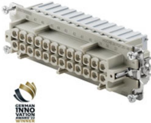
Bei dem SNAP IN-Anschluss ist die Leiteranschlussebene bereits geöffnet und der abisolierte Leiter kann einfach eingesteckt werden. In der Endposition schliesst der patentierte Klemmmechanismus automatisch. Dadurch ist sie praktisch wartungsfrei und es besteht eine sichere und dauerhafte Verbindung, welche rüttelfest ausgelegt ist. Weidmüller bietet somit als erster und einziger Hersteller diese neuartige Anschlussstechnik.
