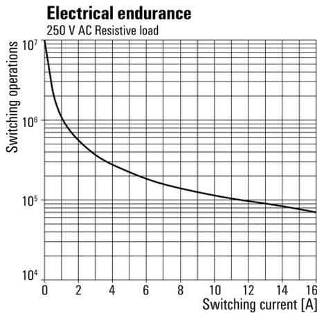
Elektrische Lebensdauer 230 V AC resistive load
