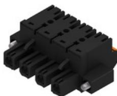
180°-Buchsenleiste mit PUSH IN Anschlussstechnologie für die Feldverdrahtung in 2,5 mm<sup>2</sup> im Raster 7.62. Erfüllt die Anforderungen gemäß UL1059 600 V Class C und IEC 61800-5-1
