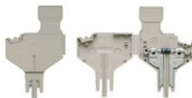
Der Bauelementestecker dient dem integrieren einer elektrischen Komponente in einer Trennreihenklemme. Nach dem Einlöten der jeweiligen Komponente lässt sich der Stecker in den Trennbereich unserer Reihenklammen integrieren und ändert dadurch die Trennklemme zu einer Reihenklemme mit integrierter elektronischen Komponente.
