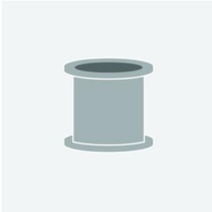
Passeinsätze dienen dem Schutz vor dem Einsatz falsch gewählter Sicherungsgrößen. Sie werden einfach in dem jeweiligen Sicherungssockel eingesetzt und verhindern den Einsatz zu großer Sicherungen.
