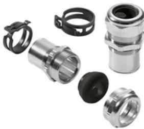
Die steigende Empfindlichkeit von elektronischen Bauteilen und die zunehmende elektromagnetische Strahlung erfordern das Kabelverschraubungen im Schirmungskonzept einer Anlage eine wichtige Rolle einnehmen. Diese Produktfamilie von EMV-Kabelverschraubungen dient zur Abschirmung gegen Störfrequenzen, sie verfügt über einen 360°-Schirmanschluss.
