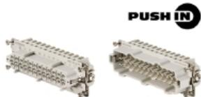
Die Push-In Anschluss Technologie ist eine Direktstecktechnik. Der vorbehandelte Leiter kann ohne zusätzliche Hilfsmittel direkt in die Leiteranschlussebene gesteckt werden.
