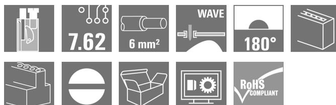
Questo morsetto per circuito stampato presenta un'unica direzione per inserimento del conduttore e collegamento a vite nel passo 7,62 mm per sezioni del cavo fino a 6,0 mm<sup>2</sup>. Direzione d'uscita del conduttore a 90° e 180°.
